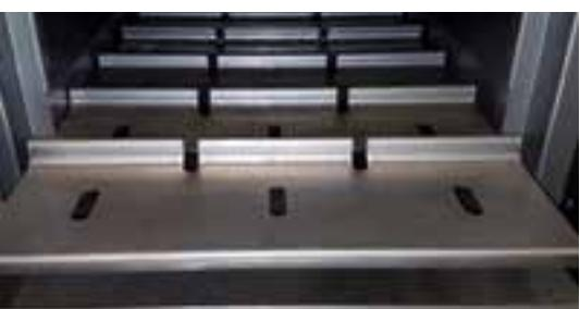
Griglia fuoco stampata con bombature e feritoie che permettono un'ottimale combustione.
